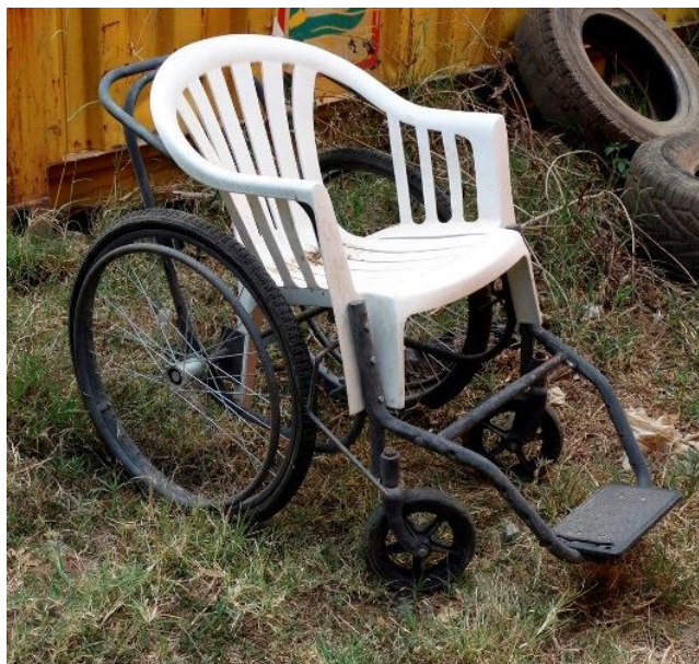
Foto 7: Soluzione ingegnosa di riutilizzo di una sedia a rotelle con seduta danneggiata
